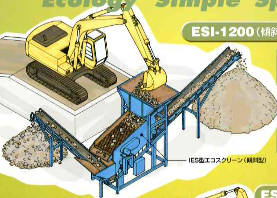
IES型 インクライン・エコスクリーン (傾斜型) 騒音レベル: 68dB (2m) <4×10スクリーン>
